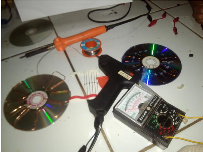
Gambar 3. Pengukuran Output Menggunakan Multimeter Analog
